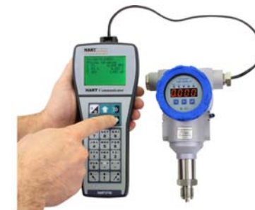
АИР-20/М2-Н в режиме конфигурирования с HART-коммуникатором
