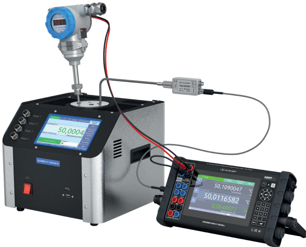
Рис. 6. ЭЛЕМЕР-ИКСУ-3000 с калибратором температуры: поверка термопреобразователя
