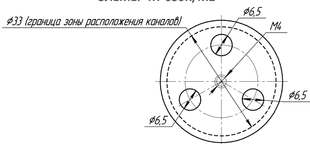
Стандартный набор каналов в блоке сравнения ЭЛЕМЕР-КТ-650К/М2
