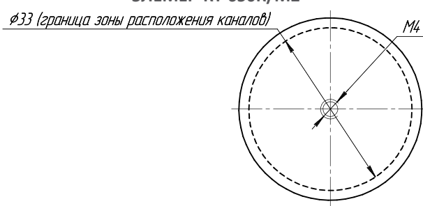
Нестандартный набор каналов в блоке сравнения ЭЛЕМЕР-КТ-650К/М2
