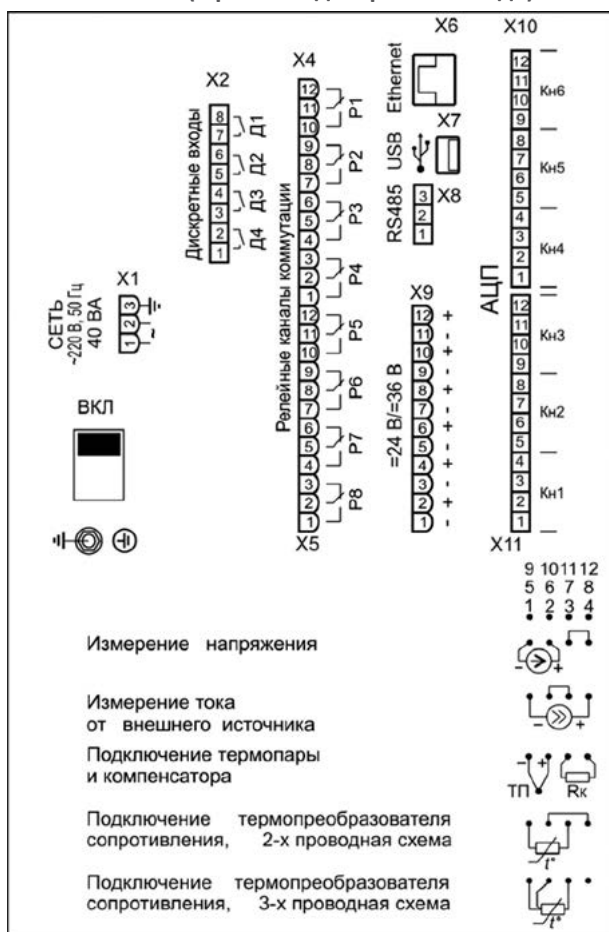
PMT 69L (8 реле + 4 дискретных входа)
