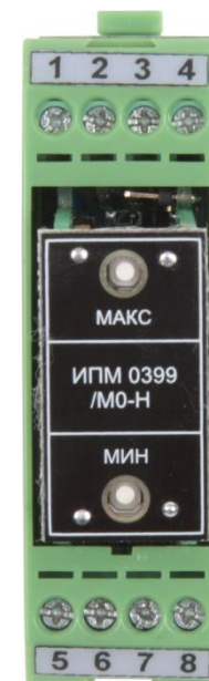
Рисунок 2.2 – Внешний вид со снятой крышкой ИПМ 0399/М0-Н
