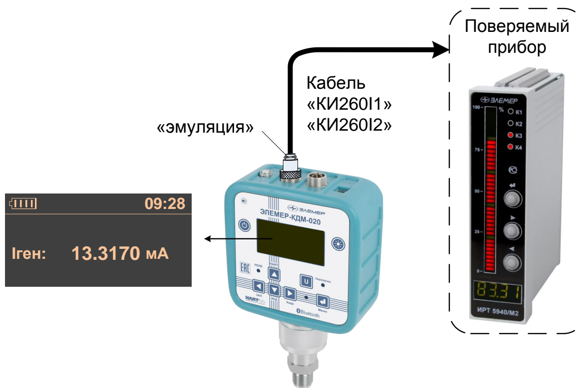
Рисунок 2.43 – Воспроизведение сигнала силы постоянного тока
