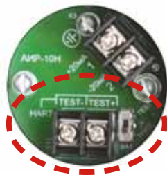
Винтовая клеммная колодка для корпуса АГ-14 с тестовыми клеммами «токовой петли» и микропереключателем для режима работы с HART-протоколом
