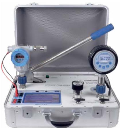
ПДЭ-020IEХ в составе калибратора давления ЭЛЕМЕР-ПКД-260
