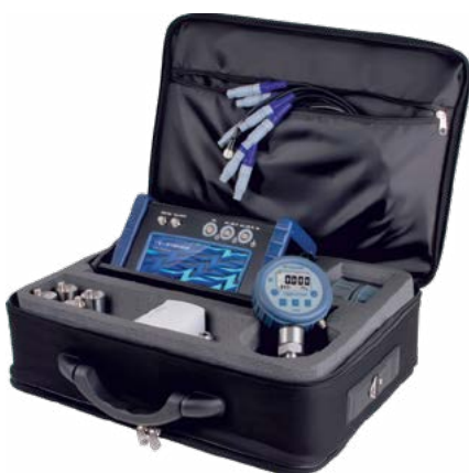
ПДЭ-020I в составе поверочного комплекта на основе ЭЛЕМЕР-ИКСУ-2012
