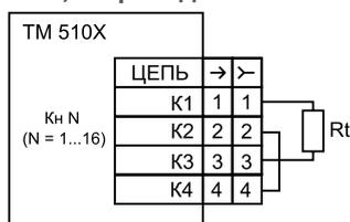
ТС, 3-проводная схема
