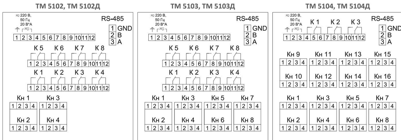
Схемы электрические подключений
