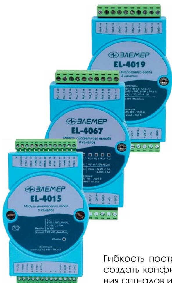
Модули УСО (устройства связи с объектом) предназначены для преобразования в цифровой сигнал первичных электрических сигналов от датчиков и преобразователей, в качестве которых могут быть использованы датчики температуры (термосопротивления, термопары), давления, влажности или любые другие преобразователи, имеющие выходной сигнал в виде силы или напряжения постоянного тока.
