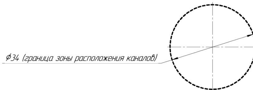
Рисунок А.2 — Эскиз сменного блока сравнения НБС-ТКП для расположения нестандартного набора каналов
