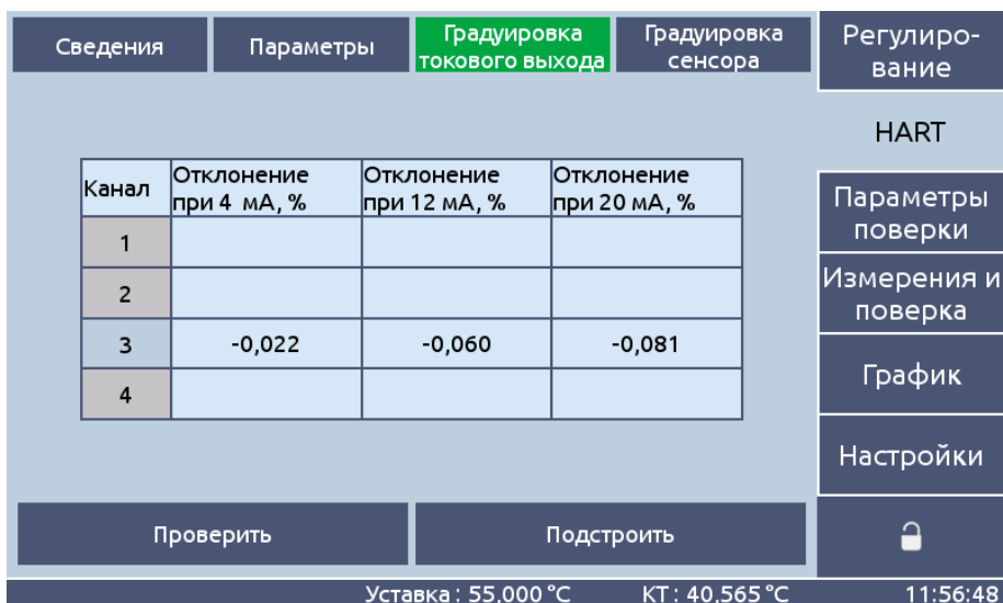
Рисунок 11 – Страница «Градуировка токового выхода». Закладка «HART»
