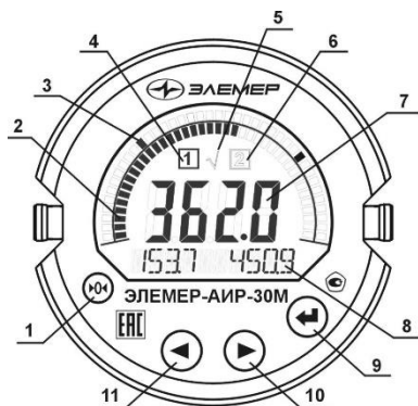
Рисунок 2.5 - Общий вид передней панели АИР-30М
