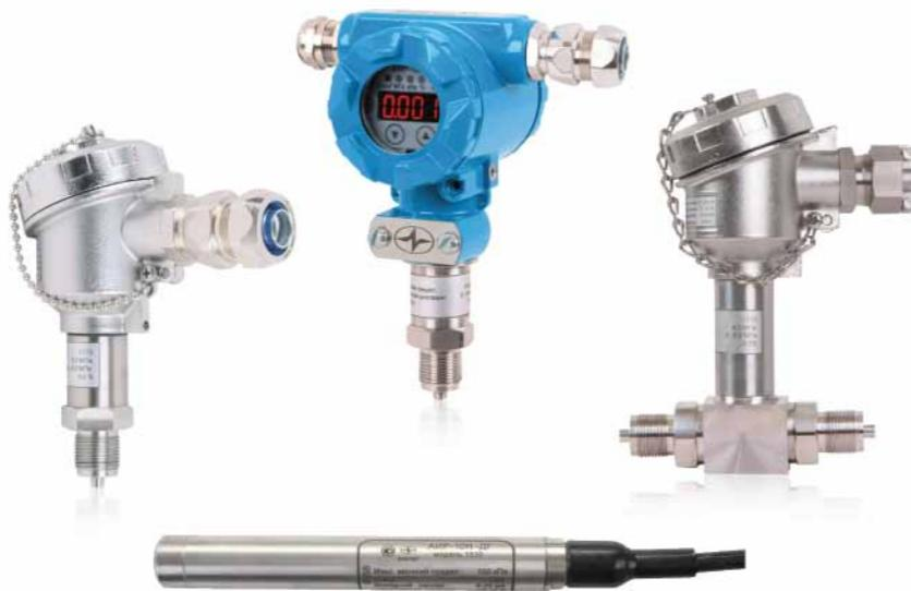
Большой выбор материалов мембран — нержавеющая сталь 316L, хастеллой, керамика на основе оксида алюминия, а также уплотнительных колец из витона (V) и стеклонаполненного фторопласта (PTFE) значительно повышают коррозионную стойкость датчика. Датчики АИР-10SH имеют практически все виды исполнений: взрывобезопасные (Exia, Exd), атомное повышенной надежности (A), морское (OM), что делает возможным применение приборов во всех отраслях промышленности.
