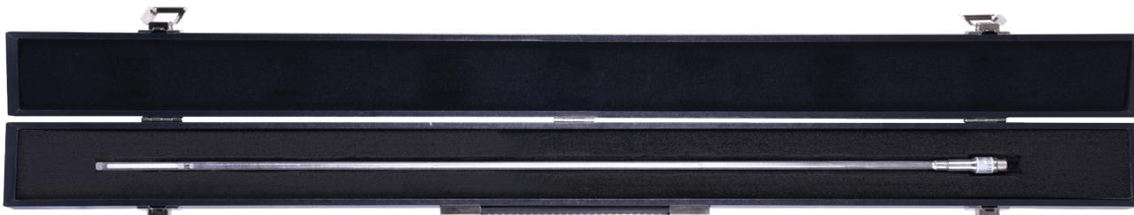
Общий вид термометра платинового эталонного серии ЭТС
