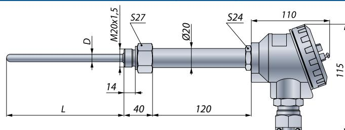
TC-1088/8-3 – Герметичность при разрушении защитной арматуры до 10 МПа, с контролем утечек
