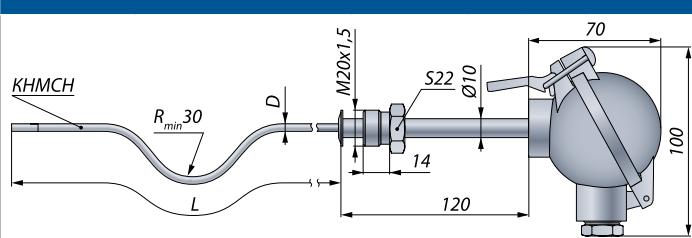
TC-1088/9-1 с использованием гибкого кабеля КНМСН
