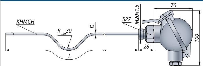
TC-1088/9-2 с использованием гибкого кабеля КНМСН
