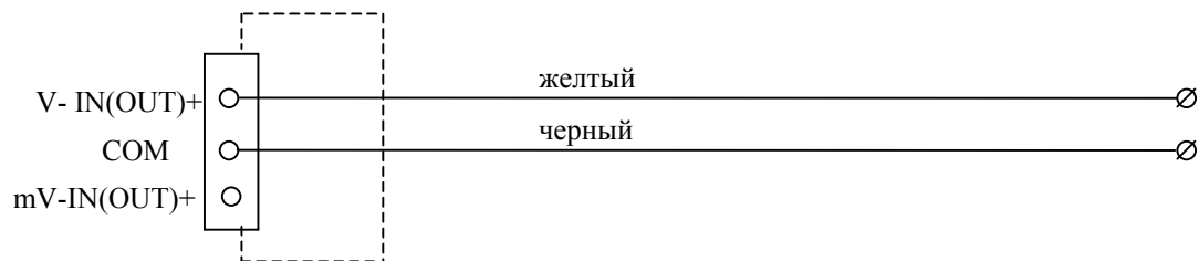
Соединительный кабель №5/2 для связи с устройствами в режимах измерения и генерации сигналов напряжения до 120 В и 12 В соответственно.
