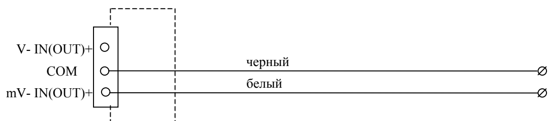
Соединительный кабель №5/1 для связи с устройствами в режимах измерения и генерации сигналов напряжения до 100 мВ.
