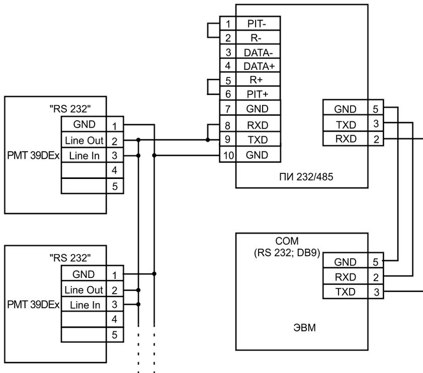
ПИ 232/485 - преобразователь интерфейса производства НПП "ЭЛЕМЕР"
