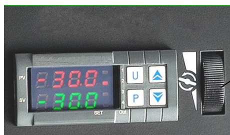
Передняя панель регулятора с ручкой для регулировки скорости вращения мешалки
