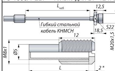
Поставляется прямым при  $L < 500$  мм. Минимально допустимый радиус изгиба монтажной части L: при хранении/транспортировке  $R_{min} = 300$  мм. при окончательном монтаже  $R_{min} = 30$  мм.
