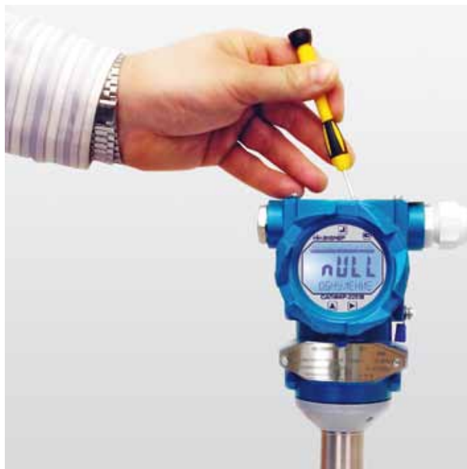
Конфигурирование датчика при помощи внешней клавиатуры
