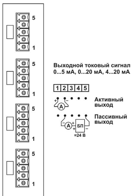
4-канальный модуль токового выхода 0...5, 0...20, 4...20 мА (тип модуля «Т4»)
