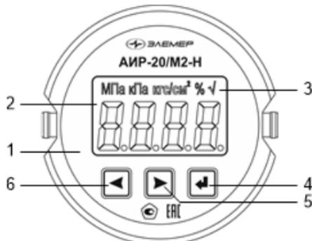
Рисунок 2.1 – Общий вид передней панели АИР-20/M2-Н с ЖК-индикатором
