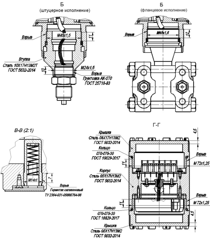
Рисунок А.7 – Чертеж средств взрывозащиты
