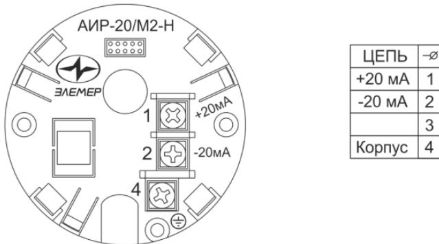
Рисунок 2.4 – Внешний вид коммутационной платы и функциональное расположение контактов для корпуса АГ-02
