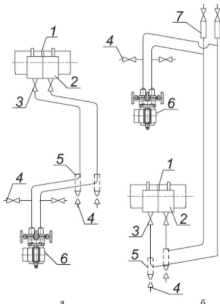
Рисунок 3.7 – Схемы импульсных линий при измерении расхода пара
