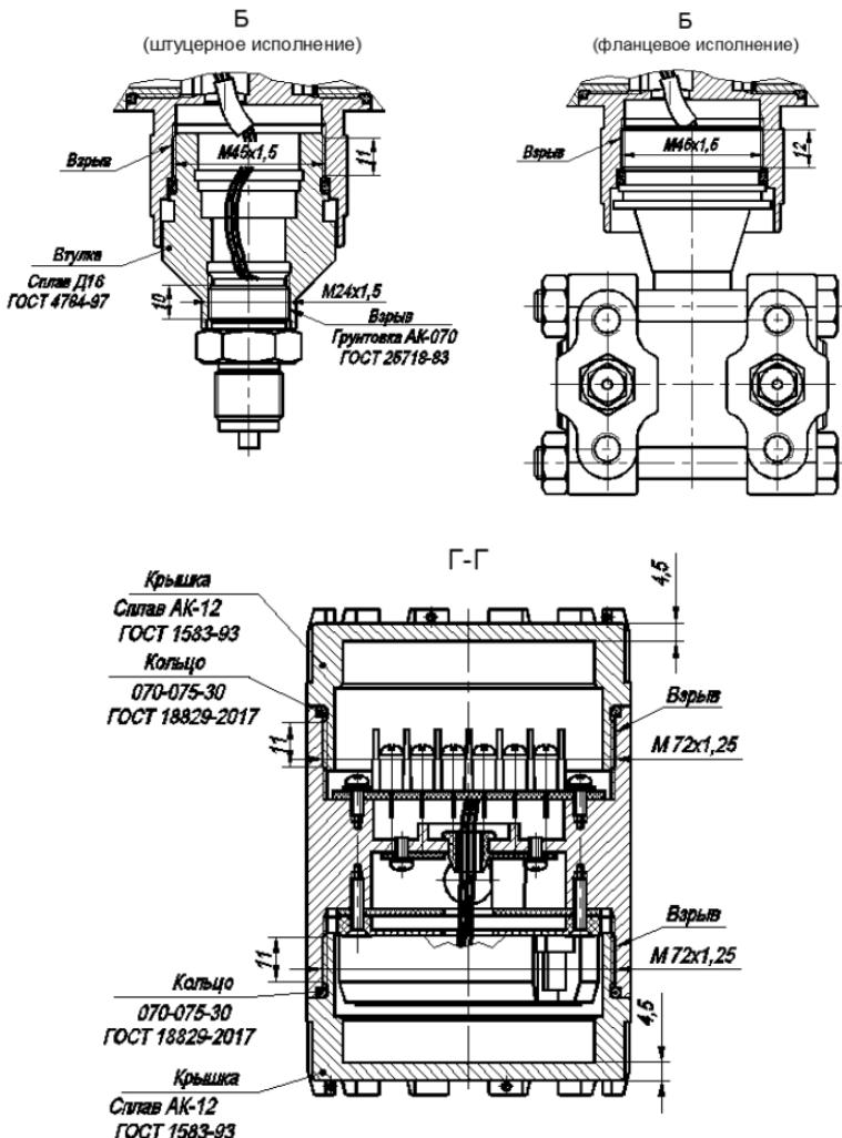
Рисунок А.4 – Чертеж средств взрывозащиты
