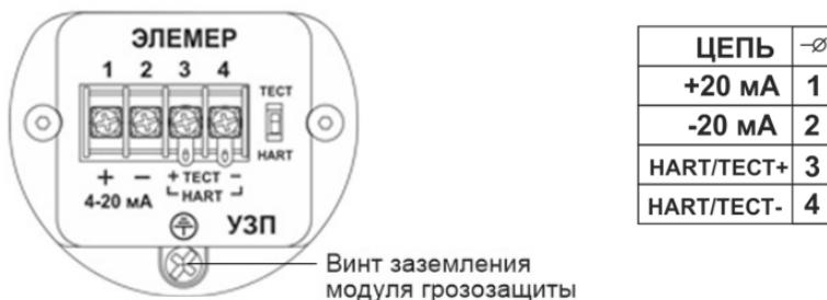
Рисунок 2.6 – Внешний вид коммутационной платы и функциональное расположение контактов для корпуса АГ-03, НГ-03 (АИР-20/M2-Н со встроенным модулем грозозащиты)
