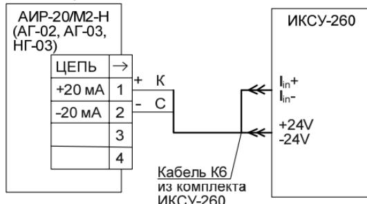
ИКСУ-260 – калибратор-измеритель унифицированных сигналов эталонный производство НПП «ЭЛЕМЕР»
