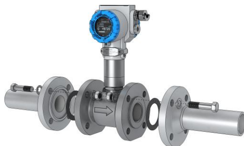
Рисунок 3.12 – Схема монтажа фланцевого расходомера в трубопровод
