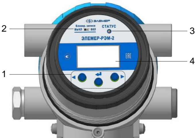
Рисунок 2.5 – Передняя панель ЭЛЕМЕР-РЭМ-2 с ВПР-02Н
