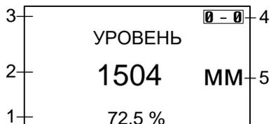
Рисунок 2.4 – Индикатор UP-31 (исполнение с индикацией)
