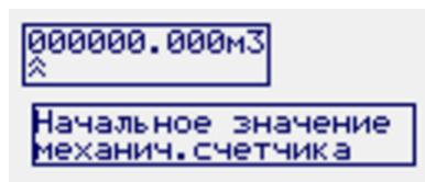
В этом окне при помощи клавиатуры  $\blacktriangle$ ,  $\blacktriangledown$ ,  $\blacktriangleright$ ,  $\blacktriangleleft$  установите значение механического счетчика и нажмите кнопку *Ввод*. Произойдет одновременный сброс интеграторов
