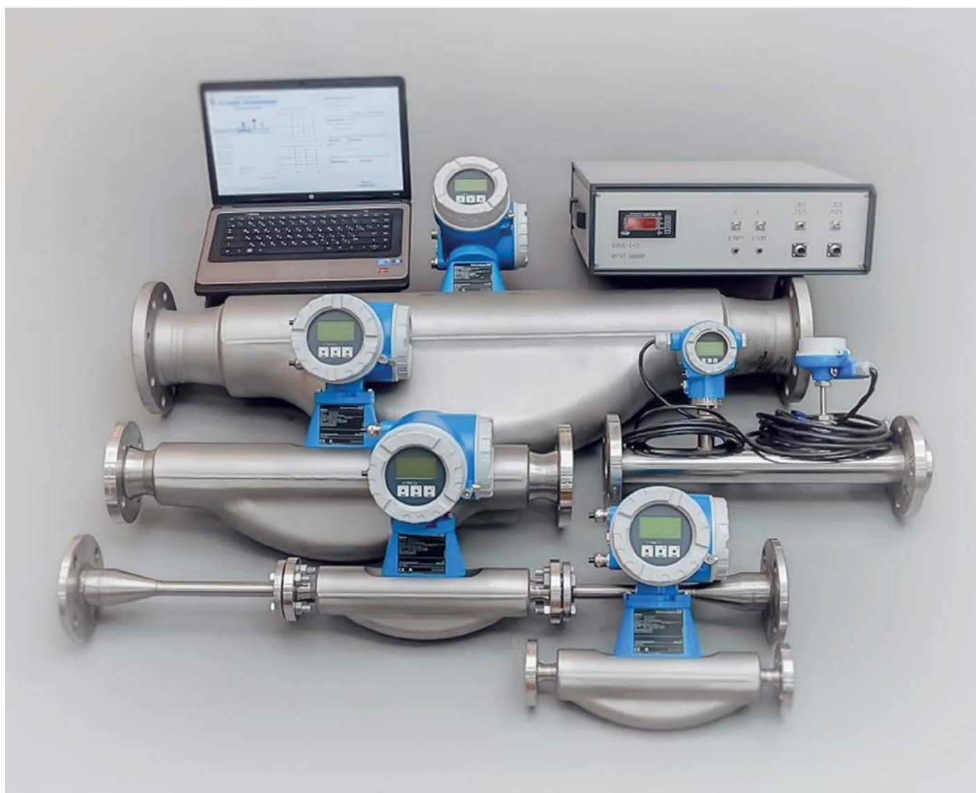
Эталон сравнения: набор массометров, БИЭС (блок измерения), ПК, аттестованное ПО.
