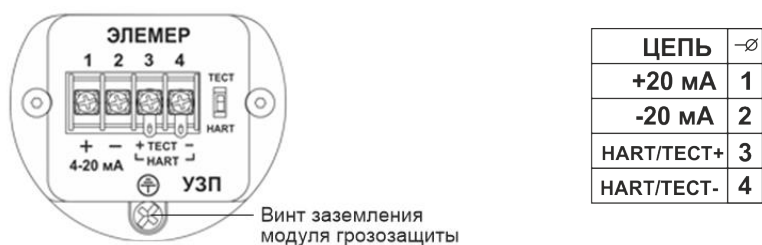
Рисунок 0.5.1 - Внешний вид коммутационной платы и функциональное расположение контактов для корпуса АГ-03, НГ-03 (АИР-20/М2-Н со встроенным модулем грозозащиты)
