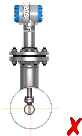
Рисунок 3.22 – Пример неверного монтажа зондового расходомера
