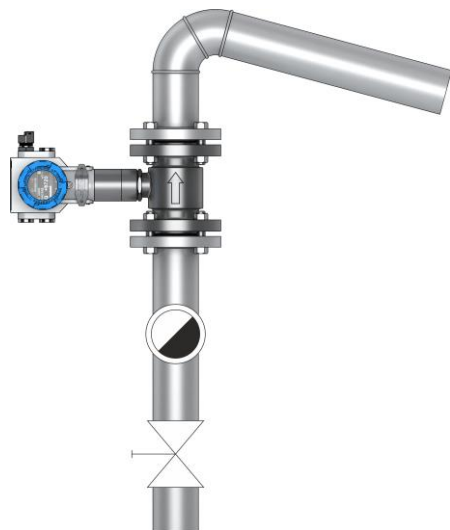
Рисунок 3.16 – Пример допустимого монтажа расходомера в вертикальный трубопровод
