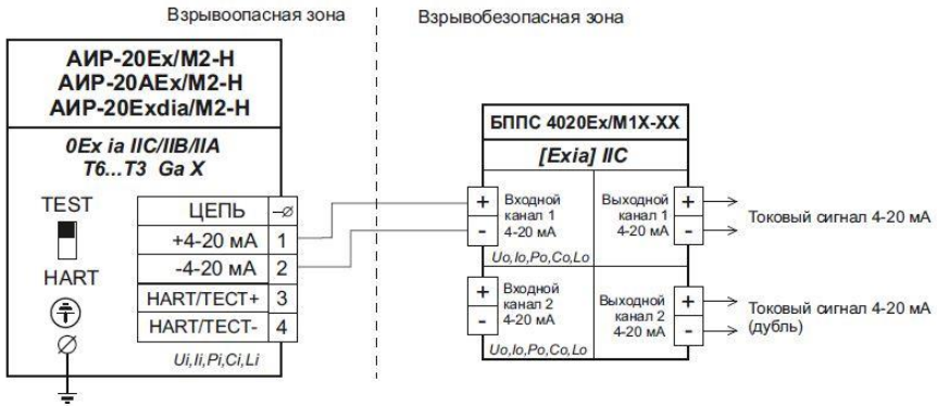
Рисунок В.12 – Схема электрическая подключений взрывозащищенных АИР-20Ex/M2-Н-ГС (подключение к БППС 4090 с искробезопасными цепями)
