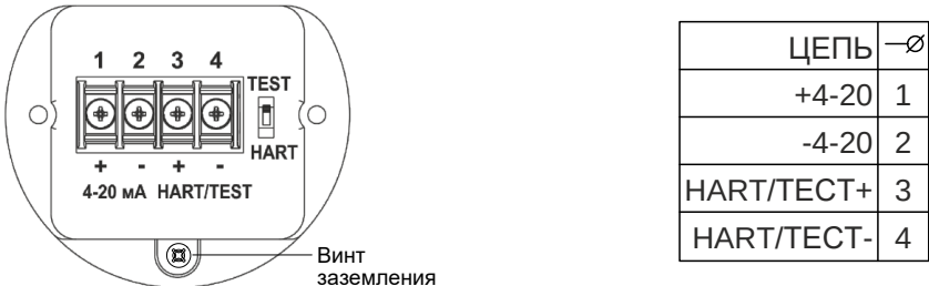
Рисунок 2.6 – Внешний вид коммутационной платы и функциональное расположение контактов
