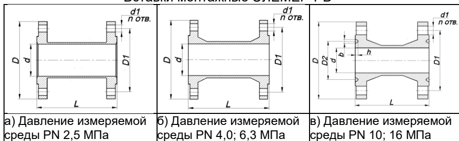
Рисунок Е.3 – Вставки монтажные ЭЛЕМЕР-РВ (тип присоединения к процессу «фланцевый»)
