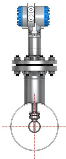
Рисунок 3.21 – Монтаж зондового расходомера
