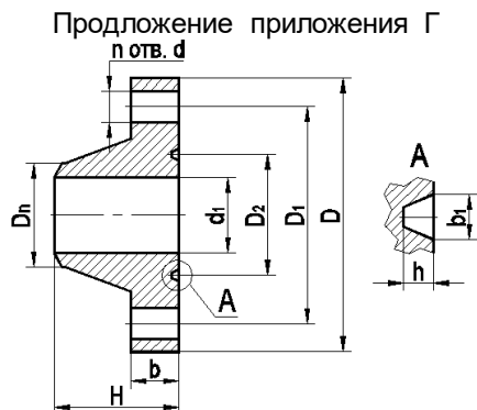
Рисунок Г.2 – Размеры фланцев «ЭЛЕМЕР-РЭМ», предназначенных для применения в системах поддержания пластового давления (ППД) (давление измеряемой среды 25, 30, 32 МПа)
