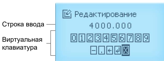
Рисунок 2.10 – Пример экрана «Редактирование» (ввод численного значения параметра с помощью виртуальной клавиатуры)
