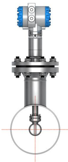
Рисунок 3.21 – Монтаж зондового расходомера
