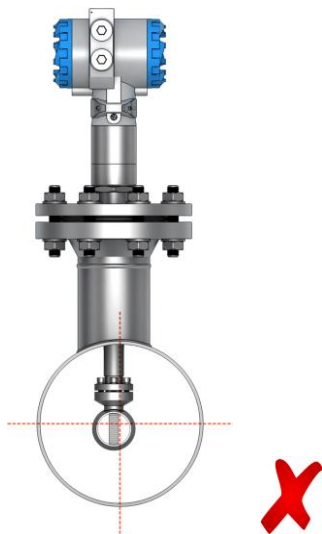
Рисунок 3.22 – Пример неверного монтажа зондового расходомера
