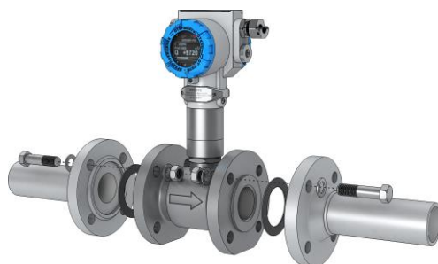
Рисунок 3.12 – Схема монтажа фланцевого расходомера в трубопровод
