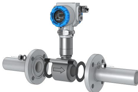
Рисунок 3.13 – Схема монтажа бесфланцевого (сэндвич) расходомера в трубопровод
