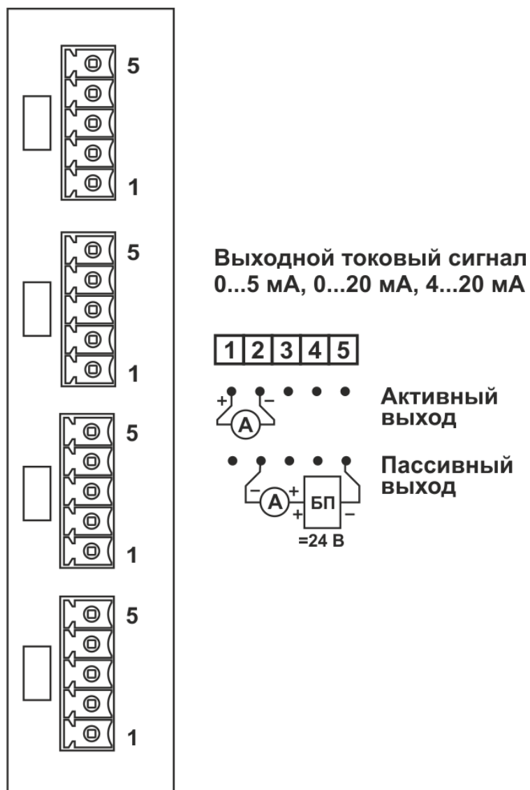
Рисунок А.7 – 4-канальный модуль токового выхода 0...5, 0...20, 4...20 мА (тип модуля «Т4»)
