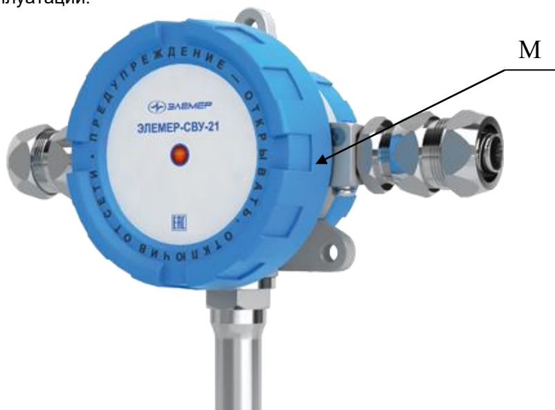
Рисунок 3.1 – Место приложения магнита при тестировании сигнализаторов (место «М» указано ориентировочно)
