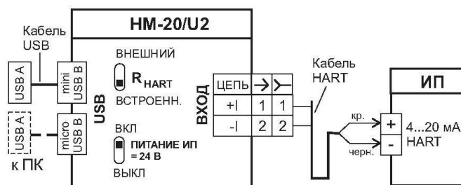
Рисунок А.1 – Подключение HM-20/U2 к ПК и ИП по токовой петле
