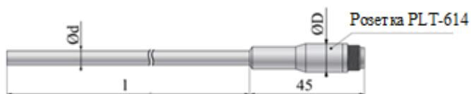
Рисунок А.3 – Термометры стержневые ПТСВ-9-2, ПТСВ-10-2, ПТСВ-11-2, ПТСВ-12-3. Габаритные размеры
