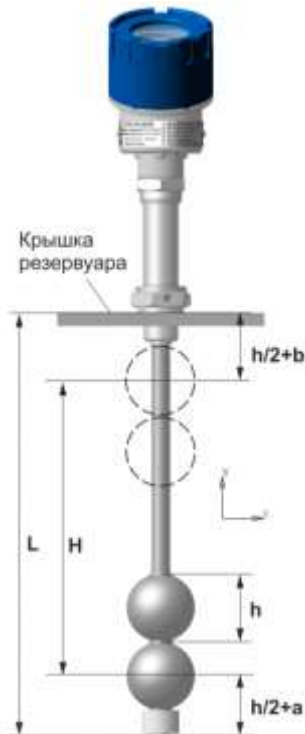
Рисунок 3.4 - Схема расчета диапазона измерений УПМ-51 с жестким измерительным элементом
