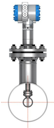
Рисунок 3.21 – Монтаж зондового расходомера
