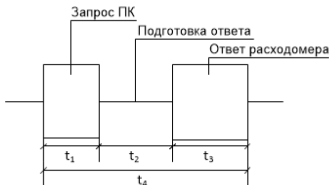
Рисунок А.1 – Временные соотношения при запросе
