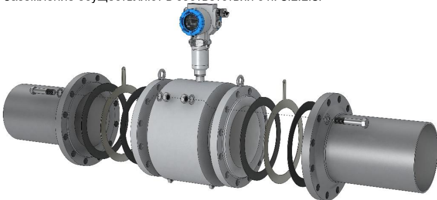
Рисунок 3.12 – Монтаж в трубопровод фланцевого расходомера с кольцами заземления 3
