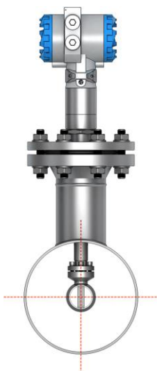
Рисунок 3.19 – Монтаж зондового расходомера
