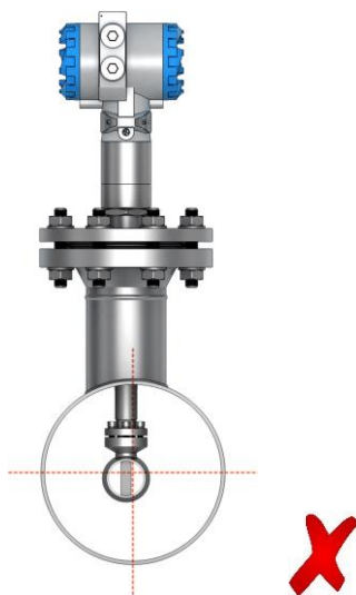
Рисунок 3.20 – Пример неверного монтажа зондового расходомера
