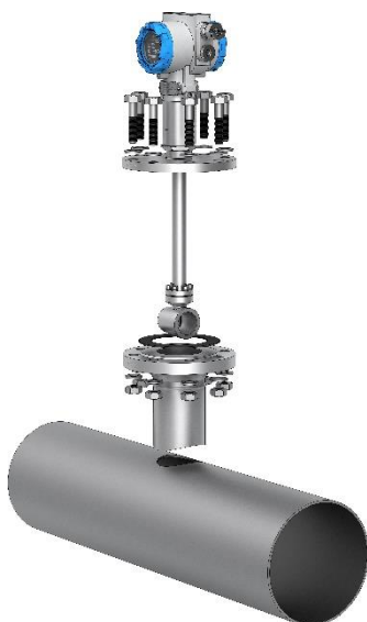
Рисунок 3.17 – Монтаж зондового расходомера
