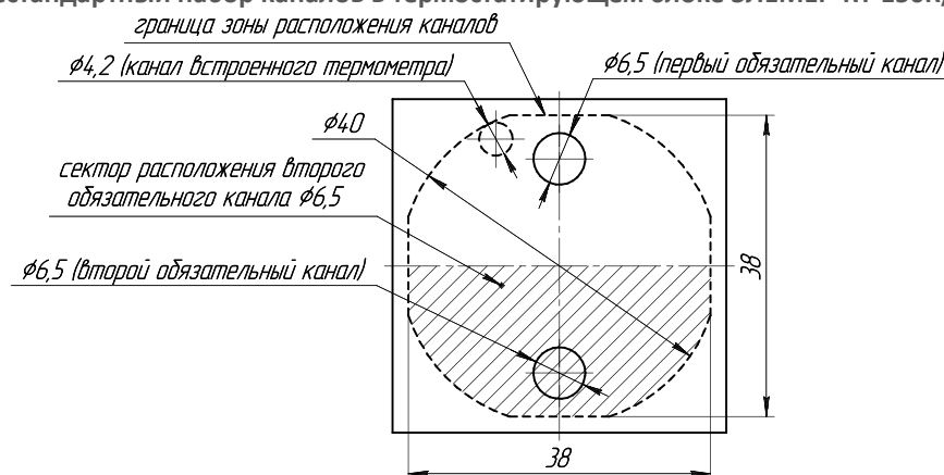
Нестандартный набор каналов в термостатирующем блоке ЭЛЕМЕР-КТ-150К/М1
